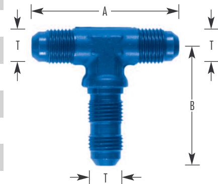
**Metric (DIN) Dichtkegel 60° / Metric (DIN) cone 60°**
